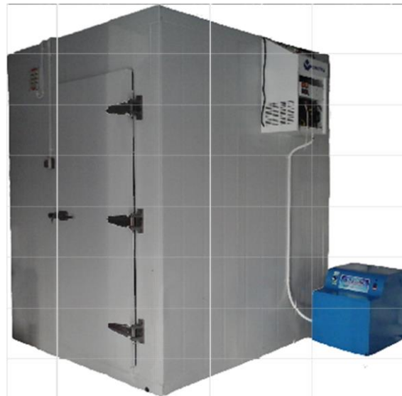
Cold storage dilengkapi pendistribusian ozon ke dalam ruang pendingin
